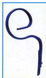
Stromo ustawione zęby wibrujące (K+L)
