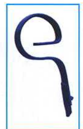
Stromo ustawione zęby wibrujące (L)
