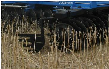
Die Einstellung des Schnittwinkels erfolgt durch eine mechanische Spindel oder einen Hydraulikzylinder (Option).
