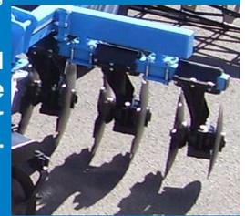
Sicherungssystem durch Gummifederung « Roll'Choc » : einfach, wartungsfrei, nimmt die Stöße auf, und folgt genau den Bodenwellen.
