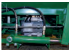
Hydrauliczna regulacja wysokości zamocowania noża
