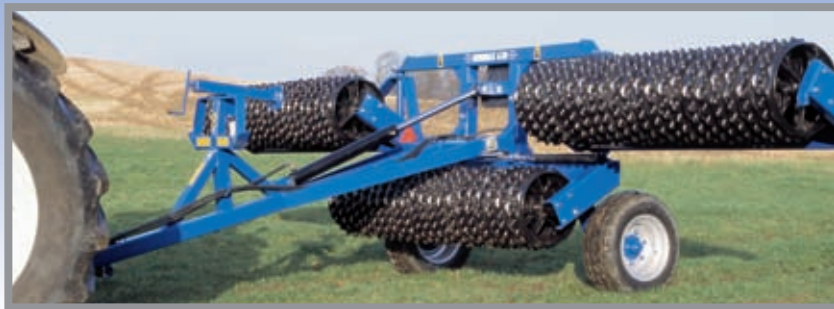
Rozkładanie sekcji bocznych odbywa się poprzez cylinder dwustronnego działania
