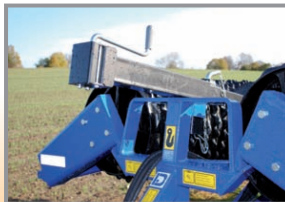
Podczas transportu wał jest położony na specjalnych uchwytach.
