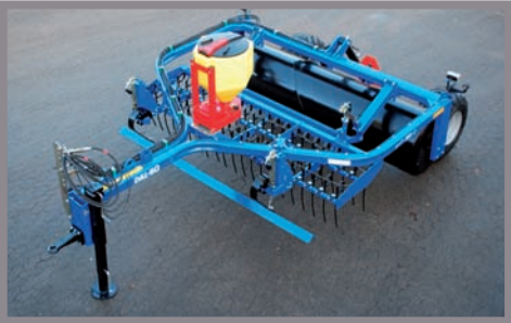
Dla nowego zasiewu Greenline 300 jest wyposażony w siewnik rotorowy.
