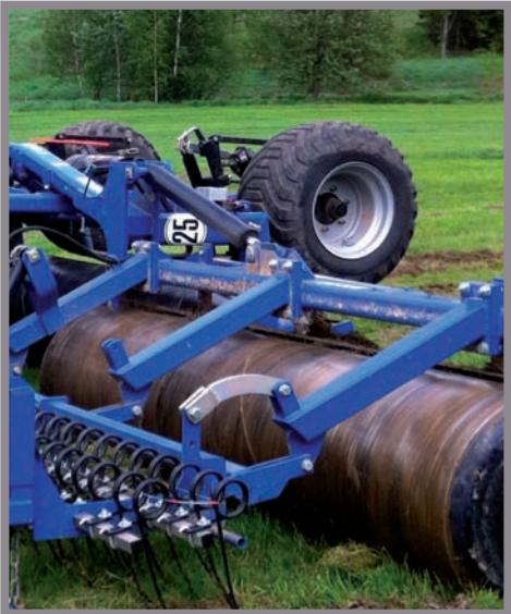
Greenline 6.30 oraz 8.30 m może być wyposażony w hamulce pneumatyczne z kołami 480/45x17 TWIN
