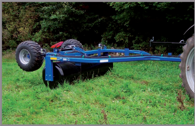
Dla nowego zasiewu Greenline 300 jest wyposażony w siewnik rotorowy.
