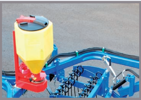
Dla nowego zasiewu Greenline 300 jest wyposażony w siewnik rotorowy.
