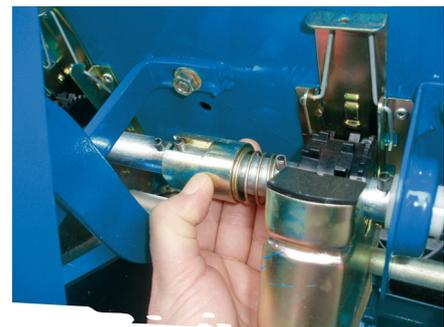
*Das Abschalten einer halben Sämaschinenbreite ist möglich (auf der linken Seite).*
