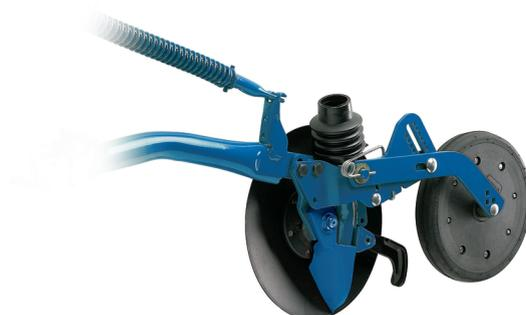
Bei bestimmten Kulturen wie z.B. Lein oder Feldgemüse, muss der Feldaufgang besonders gleichmäßig sein. Deshalb hat RABE einen Satz „Andruckrollen“ im Angebot, der an die Sägeelemente montiert wird. Die 40 mm breite Andruckrolle drückt die Saatkörner in der Rille an und sorgt dadurch für einen optimalen Kontakt zwischen dem Saatkorn und dem Boden. Die Andruckrolle verfügt über 12 Tiefenverstellmöglichkeiten, darunter eine Schnellverstellung, wenn es die Einsatzbedingungen erfordern.
