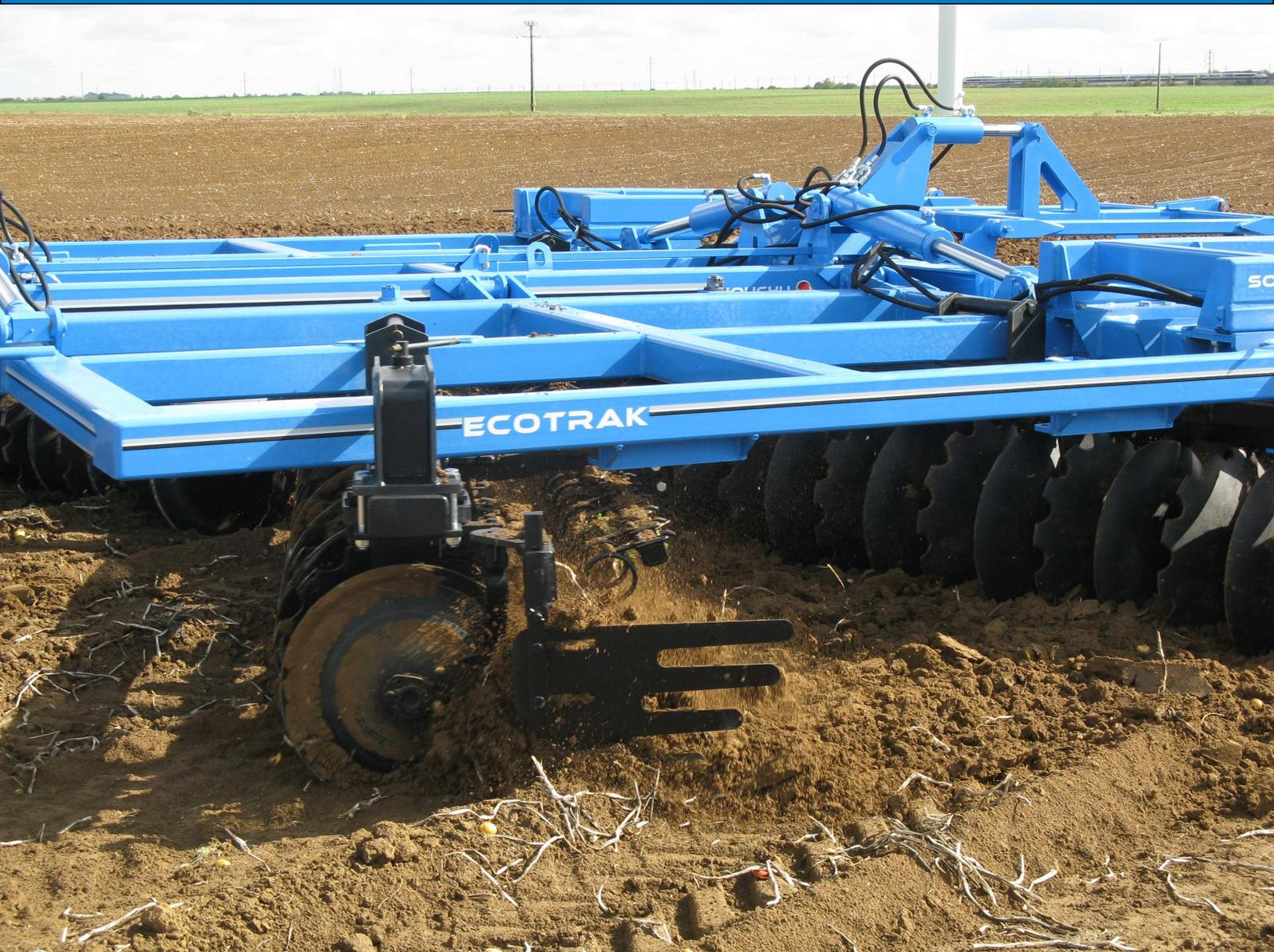
ECOTRAK ist eine neue Reihe von Scheibeneggen, konzipiert für die Stoppelbearbeitung unter nassen und klebenden Bedingungen. Gleichzeitig ist diese Maschine in der Lage auch unter normalen Verhältnissen und sogar auf schon bearbeitetem Land ein gutes Arbeitsergebnis zu erzielen.
