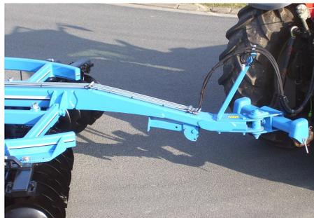
Die Schnittwinkelverstellung der vorderen Scheibensätze erfolgt mechanisch oder hydraulisch (optional)
