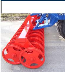
Die U-Walze ist eine Bodenrückverfestigungswalze. Die zweireihige Ausführung ist beim Einsatz in steinigem Böden stark empfohlen. Die U-Walze ist serienmäßig auf Lagern (40x40 mm) mit Lagerspritzschutz montiert.
