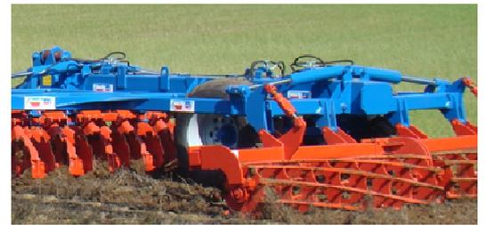
Die Walze reguliert die Arbeitstiefe der Scheibensätze. Sie rückverfestigt den Boden und verfeinert das Arbeitsergebnis. Eine breite Wahl an Walzen steht zur Verfügung.
