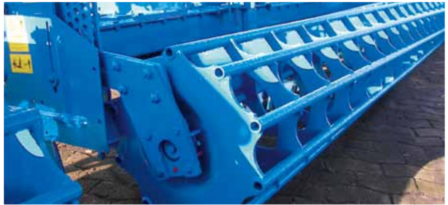
Stabpackerwalze (Ø 54 cm) Leichte Walze mit Rückverfestigung in Querrillen
