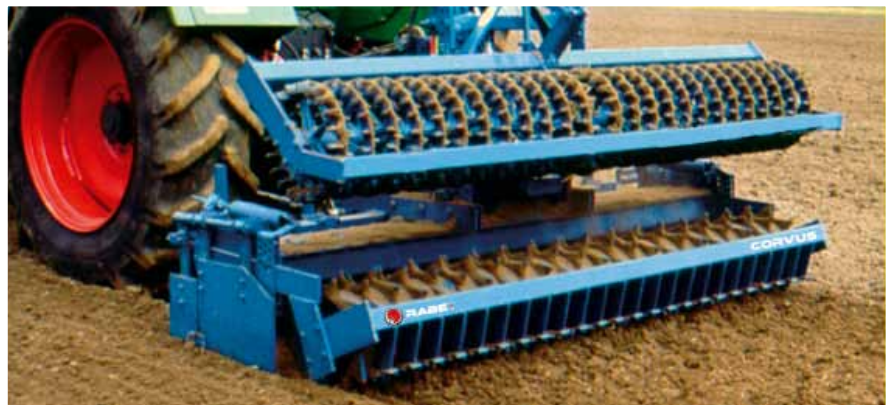
Crosskillwalze (Ø 44 cm) als zusätzliche Krümelwalze im hydraulischen Dreipunktgestänge
