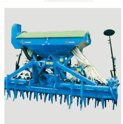
Kopplung von pneumatischen Sämaschinen über Satteldreieck
