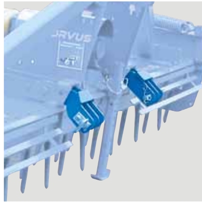
Doppelschnittiger Unterlenkeranbau, ab 4 m serienmäßig
