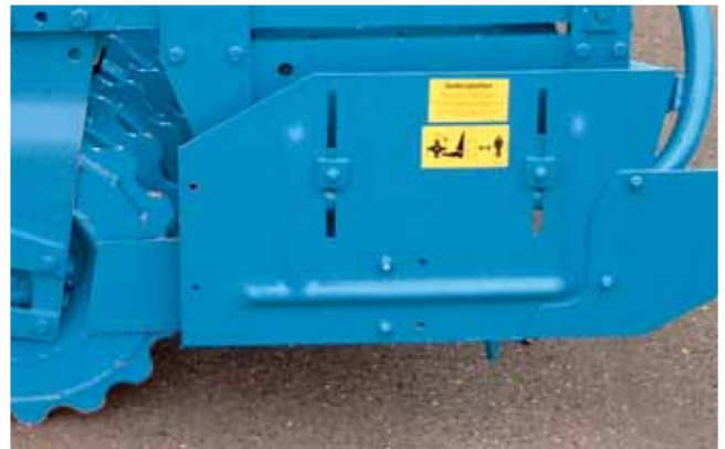
Seitenbleche höhenverstellbar mit optionalen vorderen und hinteren Bodenleitblechen
