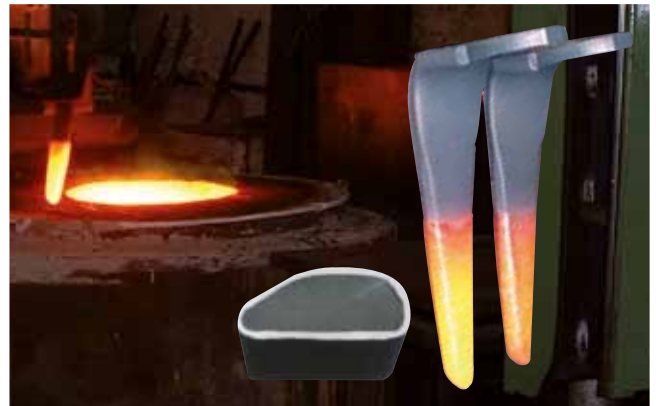
Rabid-Hartbeschichtung für bis zu dreimal längere Standzeiten
