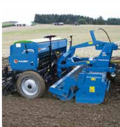
Anbau von Sämaschinen über hydraulisches oder starres Dreipunktgestänge
