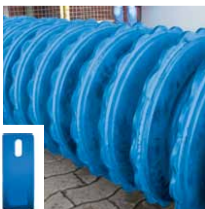
Rohr, Ringe und Wellenringe aus Stahl, hartbeschichtete Abstreifer
