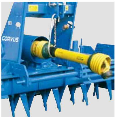
Gelenkwelle mit Reibkupplung oder Nockenabschaltkupplung
