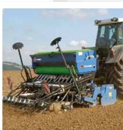
Alternativ Aufbau von Sämaschinen direkt auf der Walze
