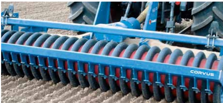
Rillenpackerwalze (Ø 58 cm) Für ganzflächige, rillenbetonte Rückverfestigung
