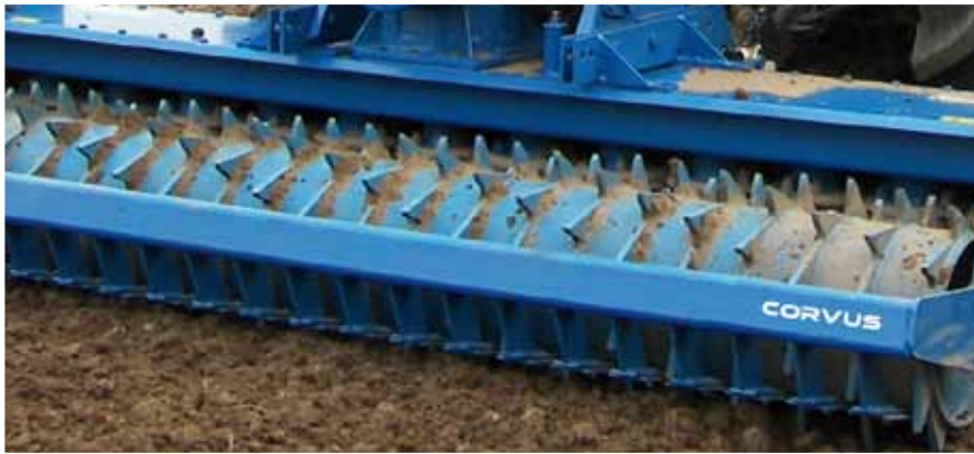
Zahnpackerwalze (Ø 51 cm) Universalwalze für ganzflächige Rückverfestigung, mit besonderer Eignung für wechselnde, steinige und feuchte Böden
