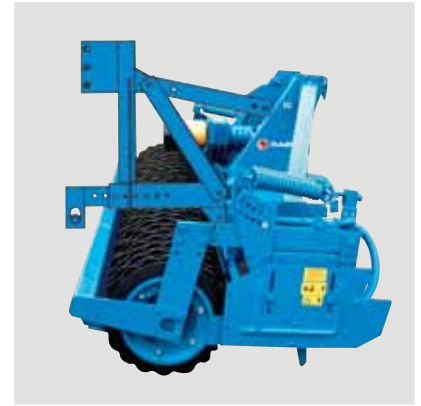
Mit Frontanbaurahmen, Zapfwelldurchtrieb und verlängerter Gelenkwelle ist der Anbau im Frontkraftheber des Schleppers möglich.
