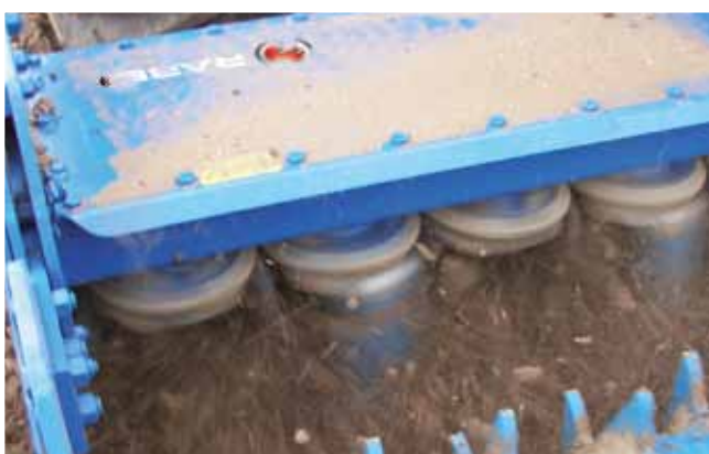
Vier kreisrunde Messerhalter pro m Arbeitsbreite, weit überlappende Messerbahnen
