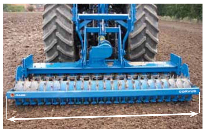
3 m und 3,5 m Arbeitsbreite = exakt 3 m und 3,5 m Transportbreite
