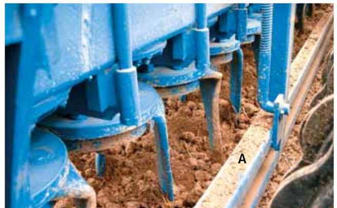
Prallblech (A) verbessert die Krümelung auf besonders harten Böden
