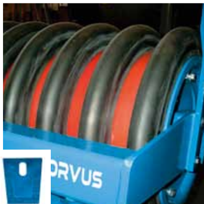
Tragrohr aus Stahl, Ringe aus zäher Gummimischung, Abstandshalter mit Klemmeffekt, hartbeschichtete Abstreifer
