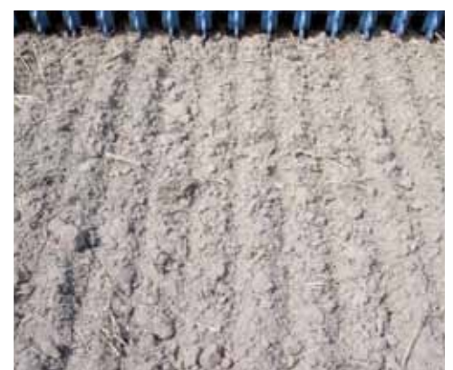
Mulchpackerwalze (Ø 50 cm) Besonders robuste Stahlwalze mit ausschließlich rillenförmiger Rückverfestigung, durch Wellenringe besonders geeignet für gemulchte Böden
