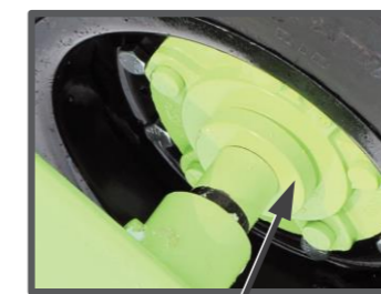
Metalowe osłony uszczelnienia łożysk na piastach 517.
