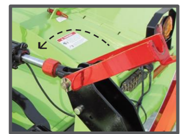
Platforma centralna z zabezpieczeniem transportowym.
