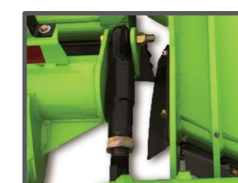
Wytrzymałe śruby rzymskie do poziomowania maszyny
