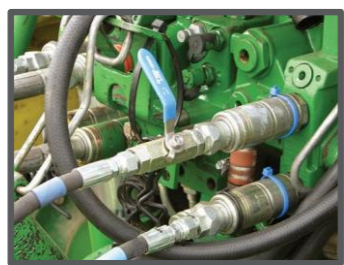
System blokady skrzydła z zaworem kulowym.
