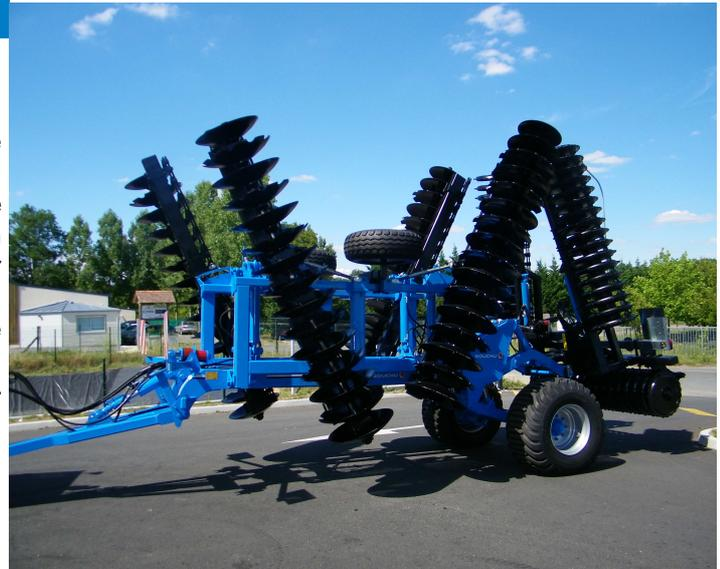
Durch das Fahrwerk der Maschine, das mit einer Dreipunkthydraulik ausgestattet ist, können auch schwere Nachläufer problemlos an die Maschine gekoppelt werden.
