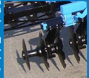
Die Roll'Choc Elastomer-Stoßdämpfer (wartungsfrei) federn Stöße ab und lassen die Maschine leicht über unebenes Gelände fahren.
