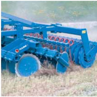
Gezackte, aggressiv arbeitende Hohl­scheiben für intensive Mulcharbeit. Wahlweise für alle Walzen vorlaufender Striegel
