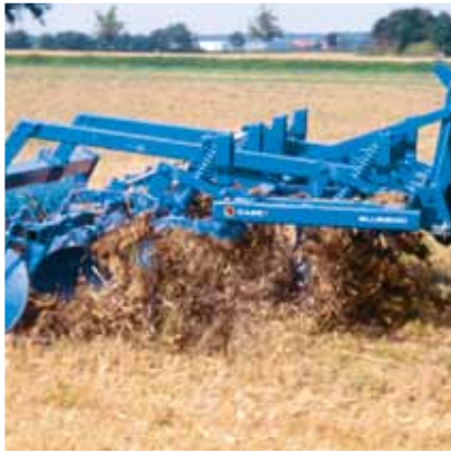
Schnellflusszinken für hohe Arbeitsgeschwindigkeit, großen Durchgang und Verstopfungsfreiheit
