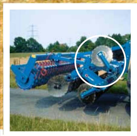
Angebaute Kurzscheibenegge Field Bird 3000 E, Arbeitsbreite und Transportbreite 3 m
