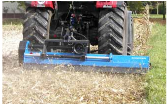
Hydraulische Seitenverschiebung für flexiblen Einsatz an Feld- und Wiesenrändern
