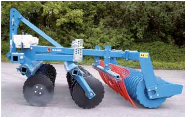
Field Bird 3000 E und Field Bird 4000 ES Gewichtserhöhung durch maximal 7 Belastungsgewichte (je 20 kg) Arbeitstiefenveränderung über Steckerverstellung der Zahnpackerwalze
