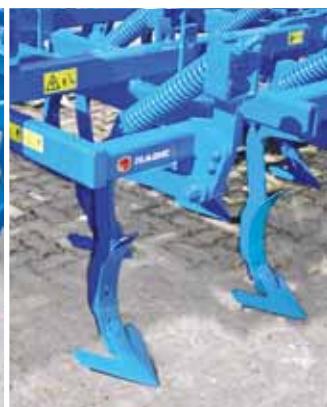
Zinken mit Federsteinsicherung
