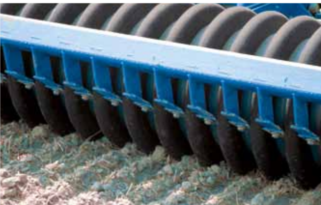
Rillenpackerwalze (Ø 58 cm) mit Blattfederzustreicher (308 kg/m), alternativ mit Hohlscheibenzustreicher (320 kg/m)
