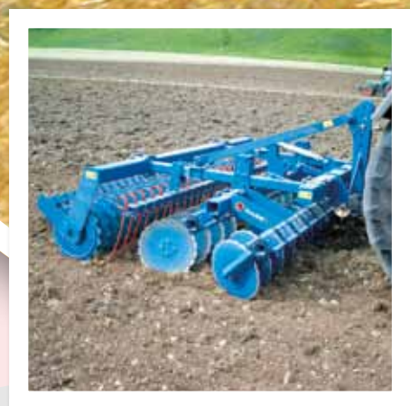
Angebaute Kurzscheibenegge Field Bird 3000 E, Arbeitsbreite und Transportbreite 3 m
