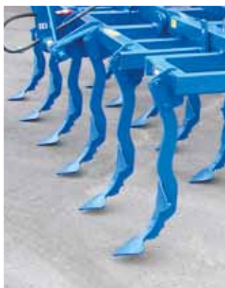
Zinken mit Scherschraubensicherung
