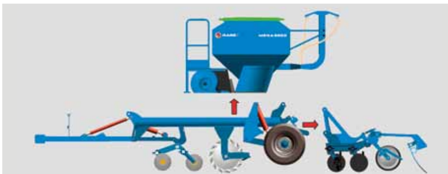
Der Field Bird 6000 KAL kann zur Mulch-Sämaschine MegaSeed erweitert werden
