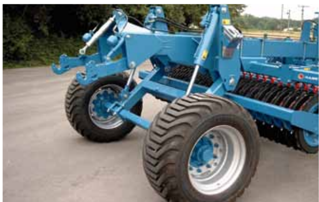
Fahrwerk (500/45-22.5) mit Druckluft-Bremsanlage und Anbaumöglichkeit für Nachfolgegeräte (optional)
