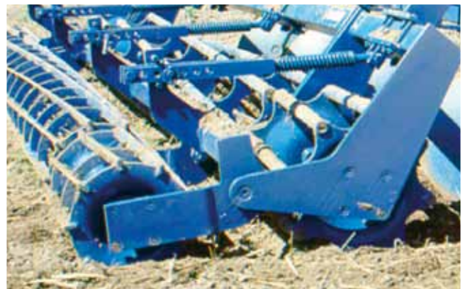
Tandemwalze (Ø 44 cm u. 35 cm) mit Hohlscheibenzustreicher (253 kg/m), alternativ mit Blattfederzustreicher (241 kg/m)
