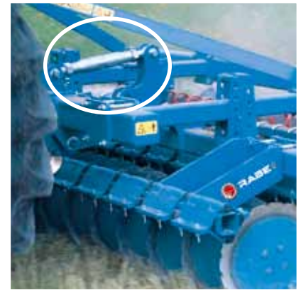
Änderung der Arbeitstiefe von 1. und 2. Reihe über Spannschlossverstellung
