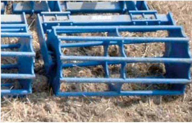
Stabpackerwalze (Ø 54 cm) mit Hohlscheibenzustreicher (235 kg/m), alternativ mit Blattfederzustreicher (223 kg/m)
