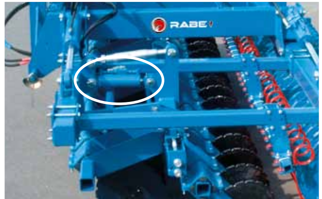
Field Bird 4000 EK Hydraulische Einstellung der Arbeitstiefe
