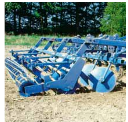
Tandemwalze = Stabpackerwalze (Ø 44 cm) und Flachstegwalze (Ø 35 cm) mit Hohlscheibenzustreicher
