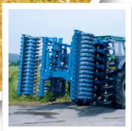
Angehängte Kurzscheibenegge Field Bird 4000 EK, hydraulisch klappbar, Transportbreite 3 m
