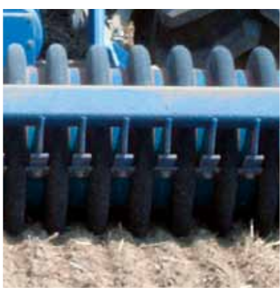
Rillenpackerwalze (51 cm oder 66 cm Ø) für ganzflächige Rückverfestigung
