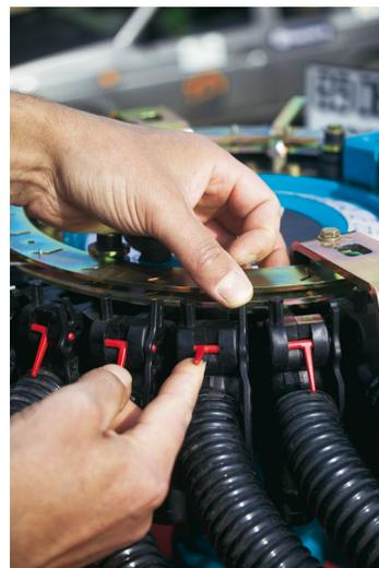
Ändern Sie **beliebig** die Anzahl der gesäten Reihen dank des Hebels an jedem Auslauf am Verteilerkopf.
