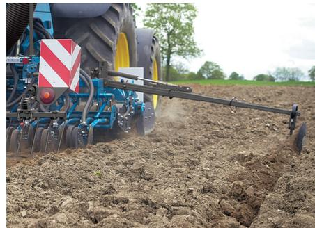
Seitliche Spuranreißer mit hydraulisch betätigter Vertikalstellung.
