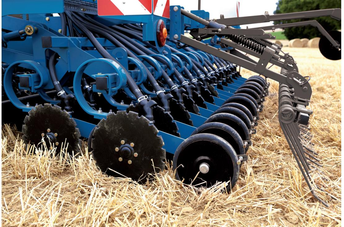
> Für eine gleichmäßige Einhaltung der Sätiefe und Rückverfestigung in allen Reihen haben alle CULTIDISC-Säelemente **genau die gleiche Länge**. Außergewöhnlich großer Schardurchgang für ein verstopfungsfreies Arbeiten: 560 mm zwischen den Reihen!
