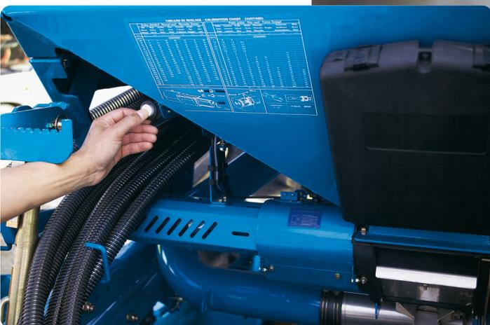
Entleerung des Dosierorgans über fernbetätigte, hinten am Saatgutbehälter angebrachte Taste zum Ein- und Ausschalten des elektrischen Motors.
