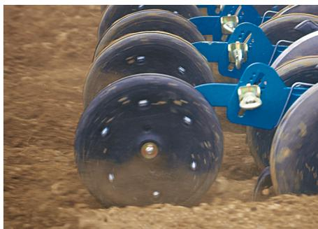
Andruckrolle 40 mm mit 8 Einstellpositionen, darunter eine schnell verschwenkbare Position; nur für UNIDISC-Säschar
