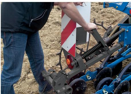
Saatriegel für eine optimale Bedeckung des Saatguts; neu ist eine leichtere Einstellung des Andrucks und des Neigungswinkels zur perfekten Anpassung an alle Einsatzfälle. Gerade oder gekrümmte Zinken, je nach Modell.
