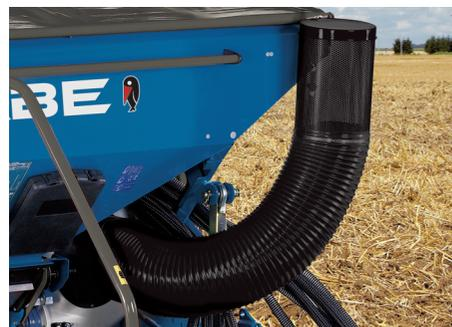
Extrabreites 6-Zoll-Gebläse mit großem Saugluftanschluss und Luftfilter, für eine optimale Gebläsefunktion in sehr staubiger Umgebung.
