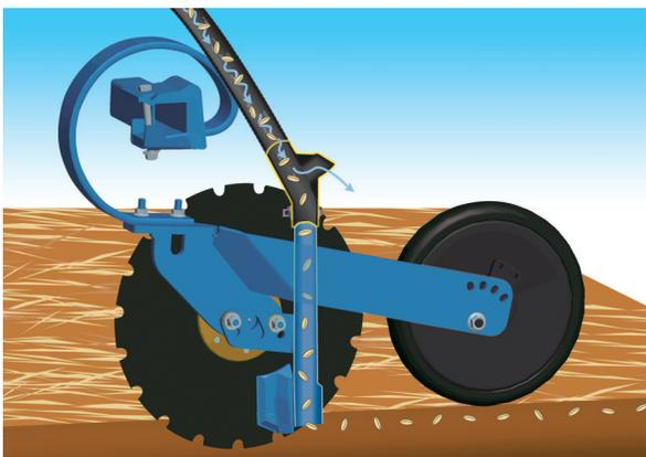
**Gezielte Ablage des Kornes** in der Tiefe durch den exklusiven **Luftkanal**, der ein Zurückspringen des Kornes verhindert und durch den Scharaufsatz mit Abflachung (die Abflachung schützt die herabfallenden Körner vor der sich drehenden Scheibe und verhindert, dass sie aus der Säfurche geworfen werden).
