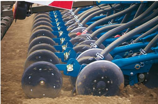
Das UNIDISC-Scharsystem beruht auf Scheiben mit großen Durchmesser. Sie bietet alle Vorteile, die zur Bewältigung großer Mengen an **Pflanzenresten** erforderlich sind, und erlaubt höhere Fahrgeschwindigkeiten.
